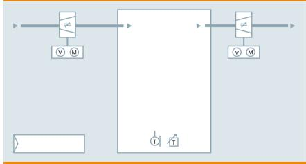
在现代建筑物中,单个房间或区域均单独送风。外部空气经过在空调机组中预处理(过滤、加热、冷却、加湿、除湿)并通过大量的管道系统传输到单个房间和区域。在出风口附近配备用于控制向区域或房间供气的风阀。OpenAir 风量控制器不仅能准确测量风量,还可以按照具体的空气要求协调风阀的开闭。
