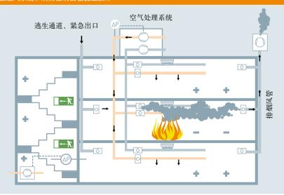
在火警或灭火系统启用时,以及在消防风阀的热断器启用或从标准状态切换为紧急操作状态时,通风系统必须能够独立关闭。这种操作模式可以确保房间有条不紊地调节过压,从而使逃生通道保持无烟雾。
