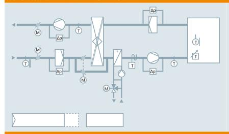
基于需求的通风设备运行操作可确保高能效通风。根据具体的设备要求和类型,必须以节能方式启用的重要设备元件包括新风、排风、回风或旁通风阀。OpenAir风阀执行器准确、可靠地满足了这些要求。
